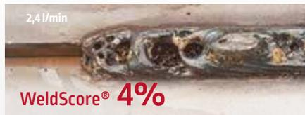
Inakzeptable Schweißnaht – Zu geringer Gasfluss führt zu offensichtlicher Porosität.
