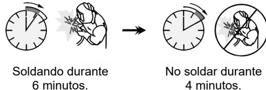
Sobrepasar el tiempo del ciclo de trabajo puede provocar la activación del circuito de protección térmica.
