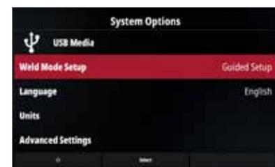
En suivant les indications sur l'écran, par la sélection de la nuance du matériau, l'épaisseur et le type de joint, le menu de configuration réglerait correctement tous les paramètres pour un soudage facile et qualitatif
