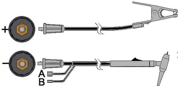
Ligue o cabo do maçarico ao terminal (-) da máquina e o grampo de trabalho ao terminal (+). Insira o conector com a chave alinhando com a chaveta e rodando aproximadamente ¼ de volta no sentido horário. Não aperte demasiadamente.
