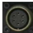
Consulte a secção de acessórios para obter uma lista de controlos remotos. Se for utilizado um controlo remoto, este vai ser ligado ao conector na frente da máquina. A máquina vai detetar automaticamente o controlo remoto, ligar o REMOTE LED (led de controlo remoto), e vai passar para o modo de controlo remoto. Na secção seguinte encontram-se mais informações sobre este modo de funcionamento.
