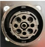
O **COOLARC 46** é alimentado pela fonte de alimentação da soldadura usando a tomada de 9 PINOS.
