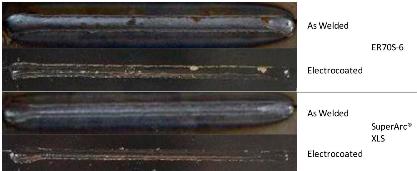
Figura 9: Comparación de SuperArc® XLS con un cable ER70S-6 estándar con soldaduras traslapadas en SPH440 sin recubrimiento
