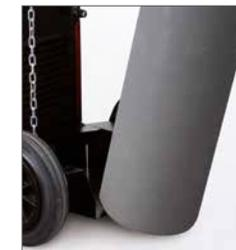
La plataforma baja del cilindro de gas facilita su carga
