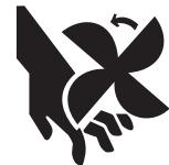
1.e. En algunos casos, podría ser necesario retirar las cubiertas de seguridad para dar el mantenimiento necesario. Retire las cubiertas solo cuando sea necesario y vuelva a colocarlas en cuanto termine de hacer la tarea por la que las haya retirado. Sea extremadamente cauteloso cuando trabaje cerca de piezas móviles.
