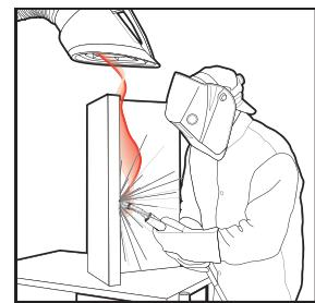
**TRABAJE EN ZONAS VENTILADAS** o instale un sistema de extracción, a fin de eliminar humos y gases de la zona de trabajo en general.
