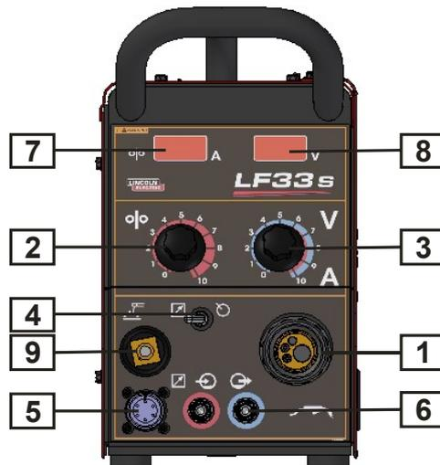
1. EURO Socket: Para conexão da tocha de soldadura.
