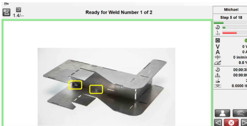
Pantalla de producción del secuenciador de soldaduras
