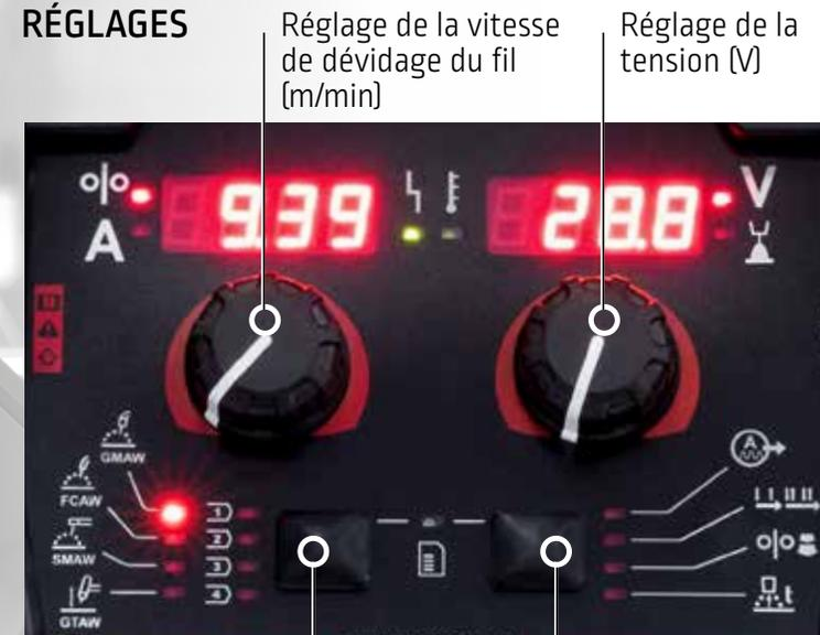
Réglage de la vitesse de dévidage du fil (m/min)
